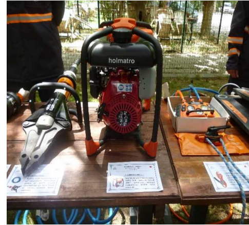
Hidrolik güç ünitesi
